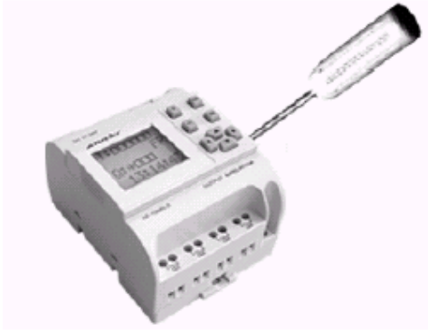
Rys. 2.2 Prawidłowe zdejmowanie panelu LCD
